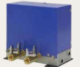
ワークが複数ある場合や、1つのワークに測定点が複数ある場合に使用します。本ユニットで2つの計測回路を切り替えできます。エアリークテスター1台で本ユニットを最大2台まで制御可能です。
